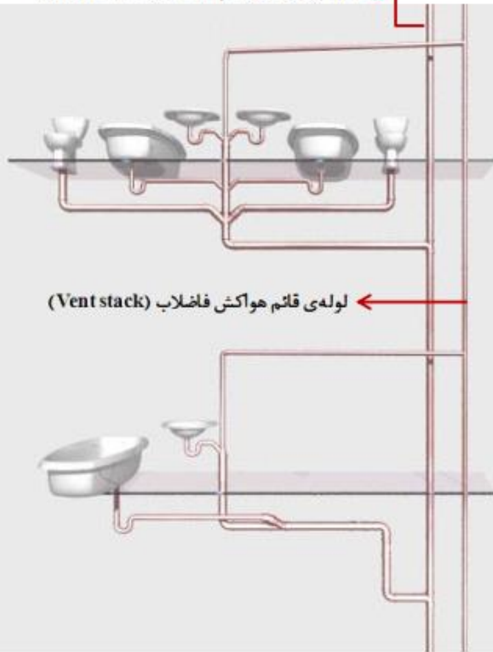
هواکش لوله‌ی قائم فاضلاب (Stack vent)
