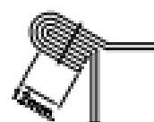
۳- جزئیات درزبندی گوشه پارچه ای قطعه قابل انعطاف
